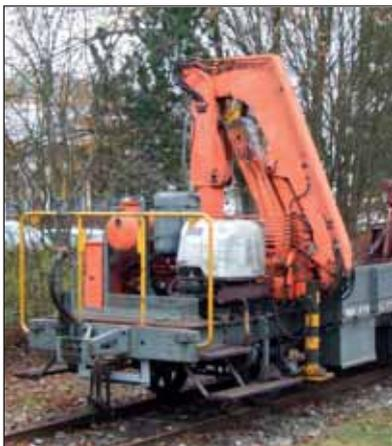
Arbeitswagen X 713 mit Ladekran Atlas 3001, Aggregat und Hydraulikölbehälter
